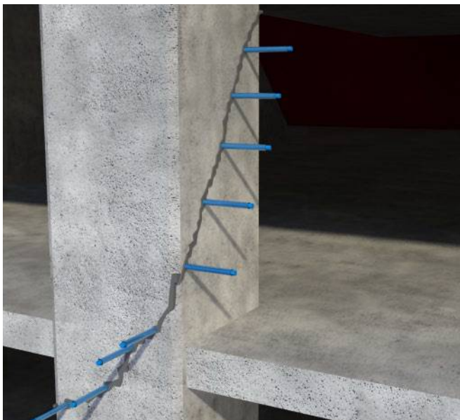
Durante la inyección del producto
